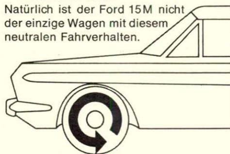
Aber er ist einer der wenigen, der sein Verhalten auch bei Seitenwind nicht ändert. Der Grund dafür liegt im kompakten Frontantriebsblock, der den Schwerpunkt des Ford 15M dahin verlegt, wo auch der Seitenwind gefährlich wird: vor die Wagenmitte. Seitenwindböen müssen beim Ford 15M gegen das ganze Fahrzeuggewicht ankämpfen. Deshalb reicht ihre Kraft nicht aus, ihn aus seiner Bahn zu drängen.
