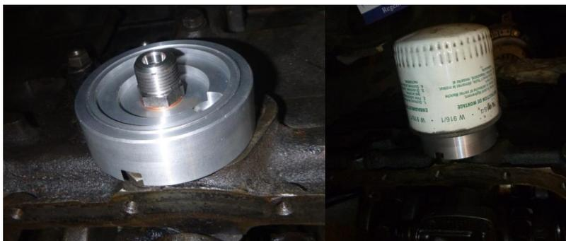
Adapterring und Dichtung an Ölfilter leicht mit Öl benetzen. Ölfilter mit Öl füllen und montieren.
