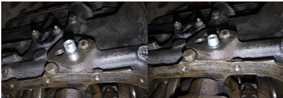
Flanschfläche reinigen und auf Verzug überprüfen. Aluminium Hohlschraube M14 eindrehen und mit Gabelschlüssel handfest anziehen. Dichtring überziehen.
