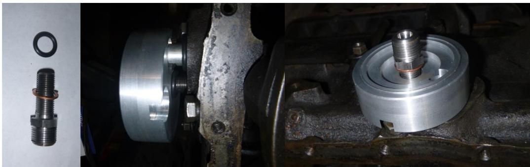
Hohlschraube M14/M20 mit Dichtringen und Adapterring am Motorblock ansetzen. Sitz der Dichtringe zwischen Adapterring und Motorblock überprüfen. Hohlschraube festziehen.
