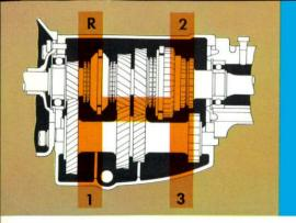
Die elastischen Taunus-Motoren braucht man nicht viel zu schalten. Der Taunus 17M wird deshalb serienmäßig mit dem vollsynchronisierten 3-Gang-Getriebe ausgestattet. Die Gänge sind so gut abgestuft, daß es der Motor nicht übel nimmt, wenn Sie einmal im großen Gang "bummeln".
