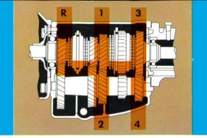
Wer gerne sportlich fährt oder in den Bergen zu Hause ist, der will natürlich öfter schalten und wird deshalb das vollsynchronisierte 4-Gang-Getriebe vorziehen. Es hat genau wie das 3-Gang-Getriebe kurze, exakte Schaltwege und läßt sich mit dem kleinen Finger bedienen.
