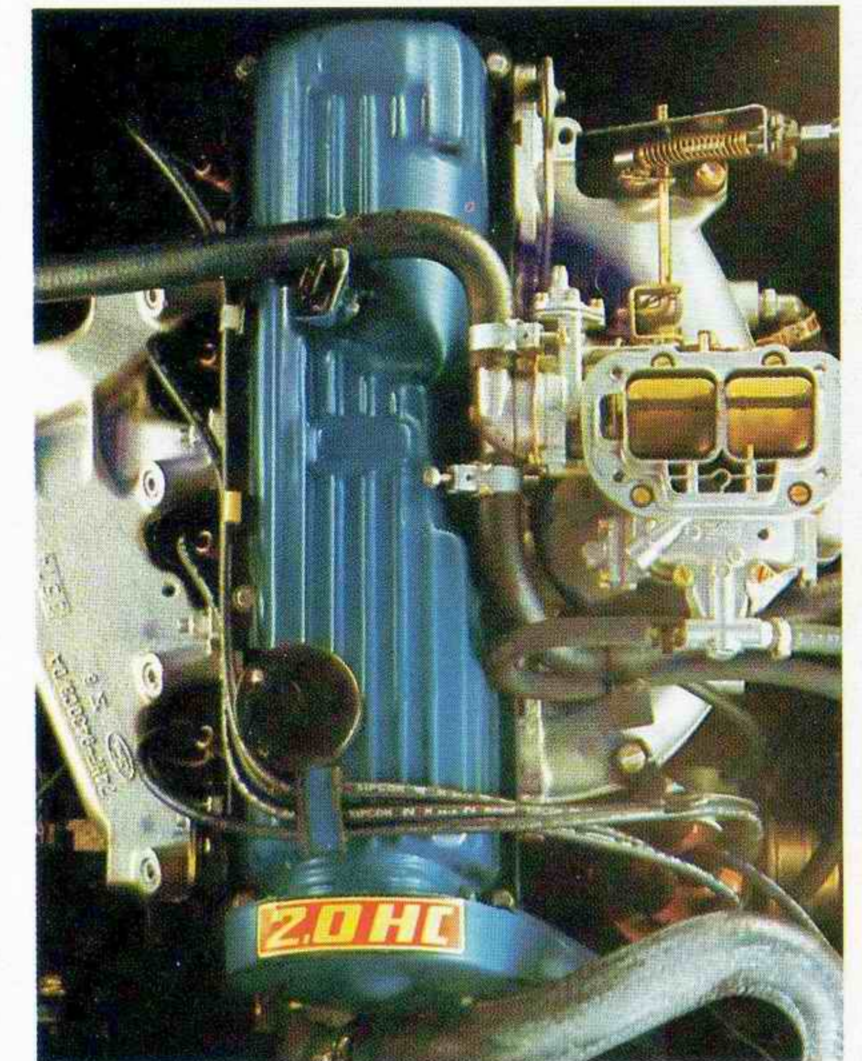
Der 2-Liter-OHC: 98 PS (abgebildet ohne Luftfilter)
