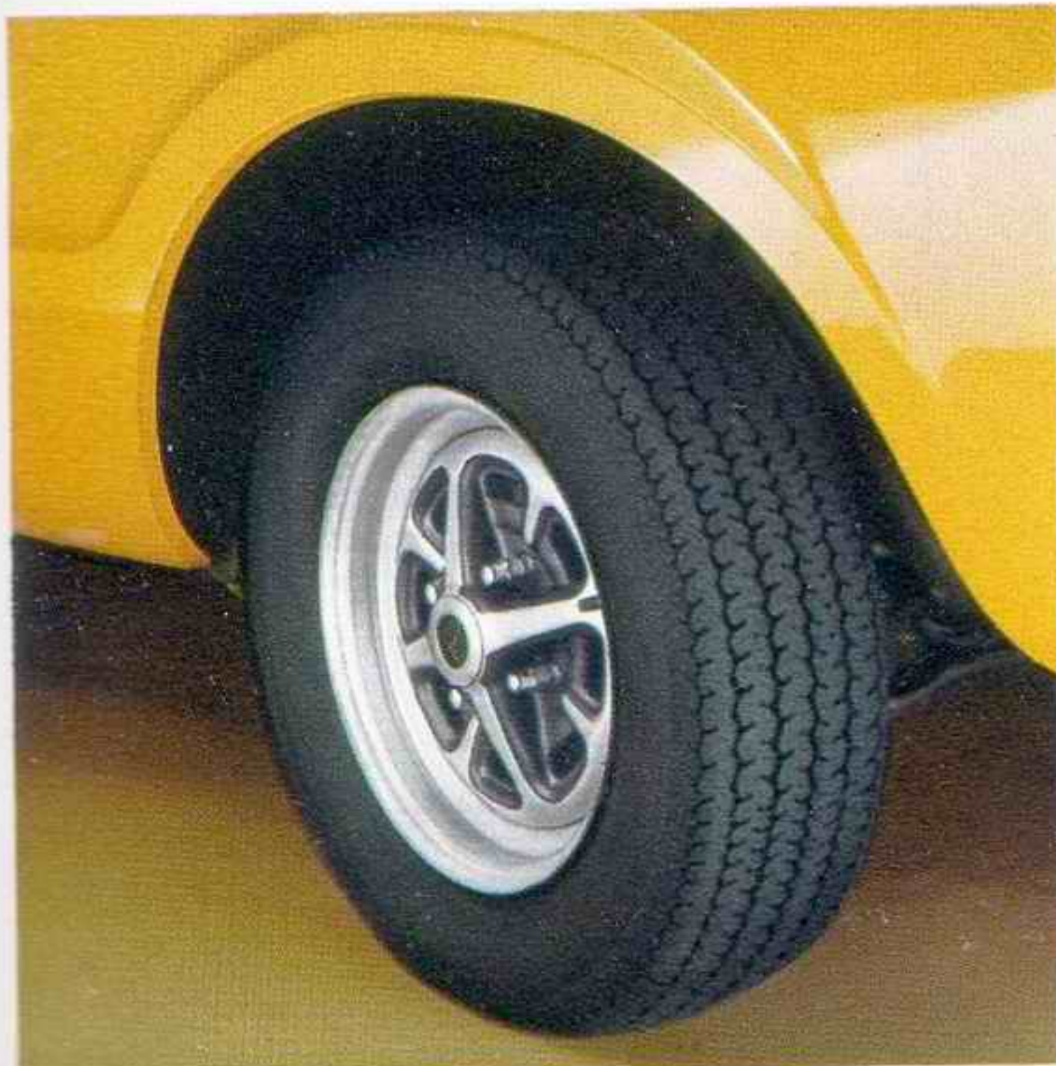
Sportfelgen und Hochgeschwindigkeits-Gürtelreifen 185/70 HR 13
