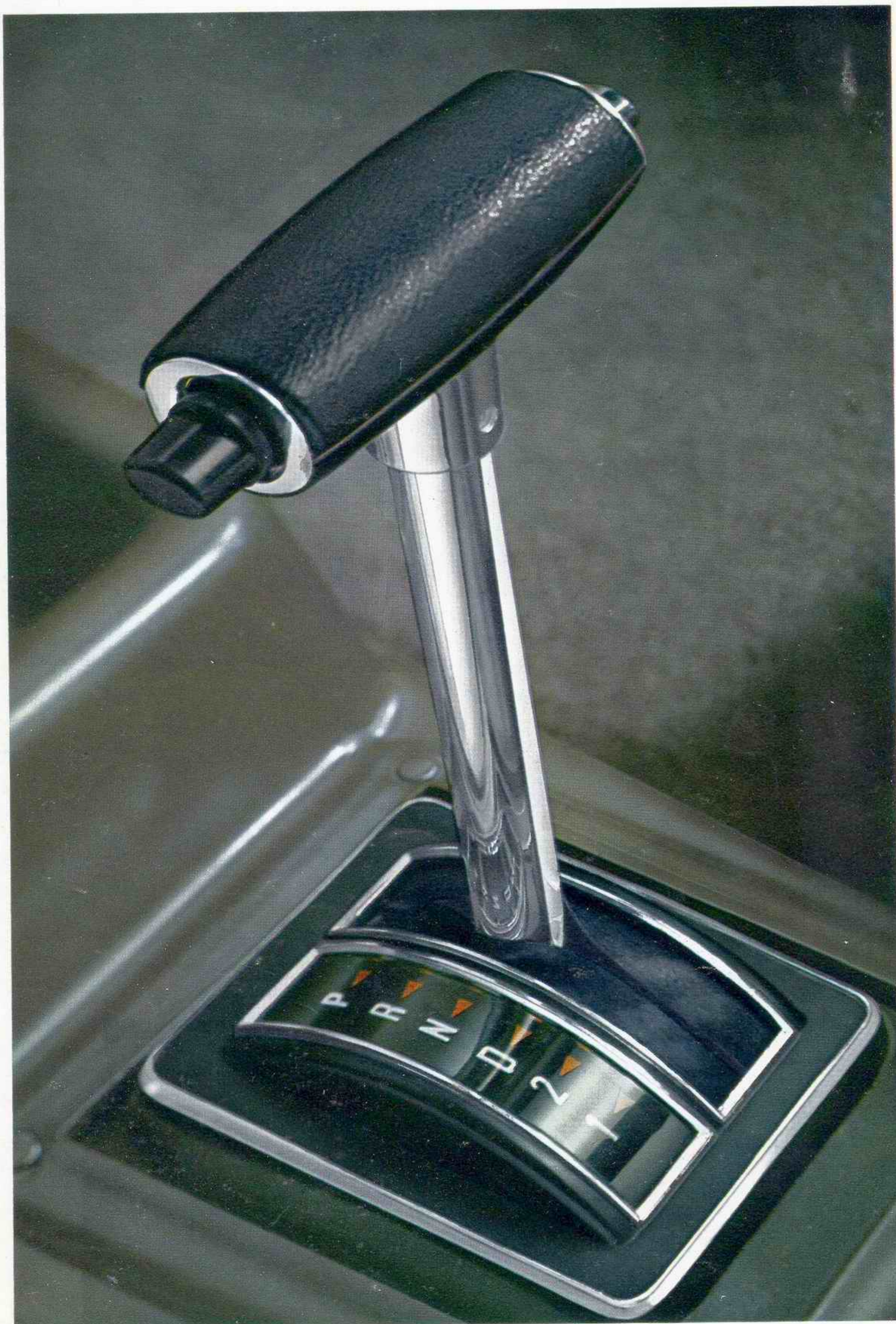
Mittelwählhebel für die Ford-Vollautomatik
