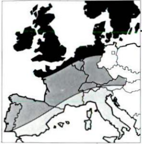
Ein weiteres Ergebnis der intensiven Korrosionsforschung – die Rost-Landkarte. Sie zeigt: Der nördliche Teil der Bundesrepublik liegt in der extrem rostintensiven Zone, der Süden immer noch im Bereich starker Gefährdung.
