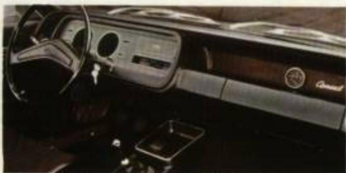
▲ Armaturenfront aus stoßabsorbierendem Material.
