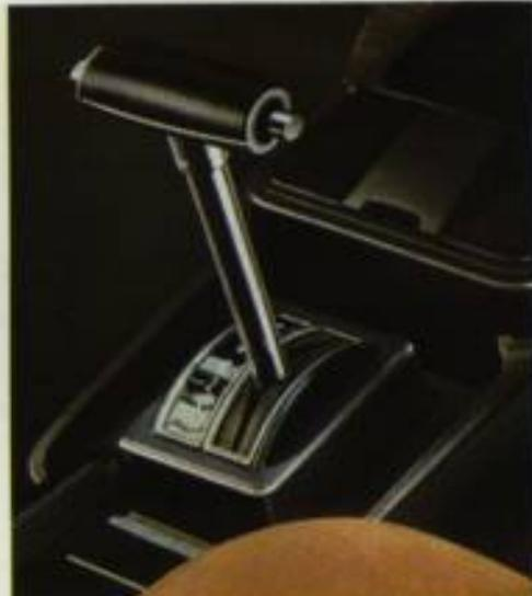
▲ Ford-Vollautomatik mit Mittelwählhebel.
