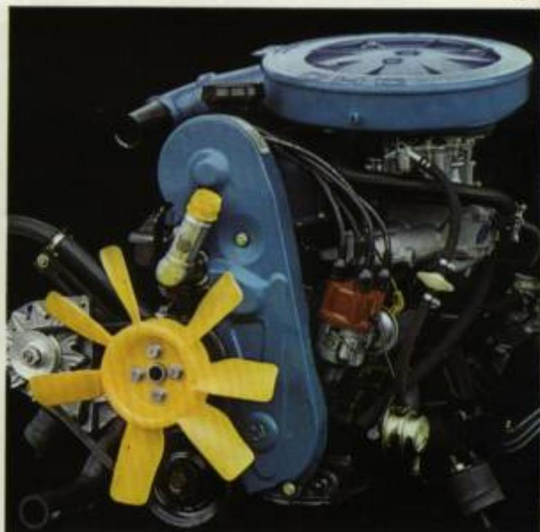
▲ Der drehzahlfeste 2,0-Liter-Reihenmotor mit obenliegender Nockenwelle.
