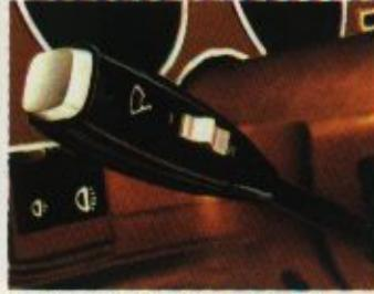
▲ Mehrfunktionenhebel an der Lenksäule.
