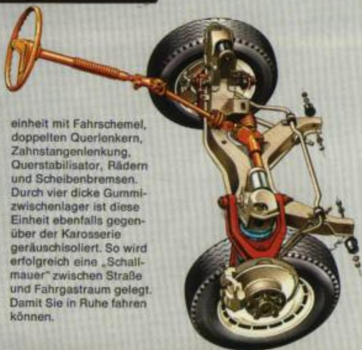
einheit mit Fahrschemel, doppelten Querlenkern, Zahnstangenlenkung, Querstabilisator, Rädern und Scheibenbremsen. Durch vier dicke Gummizwischenlager ist diese Einheit ebenfalls gegenüber der Karosserie geräuschisoliert. So wird erfolgreich eine „Schallmauer“ zwischen Straße und Fahrgastraum gelegt. Damit Sie in Ruhe fahren können.
