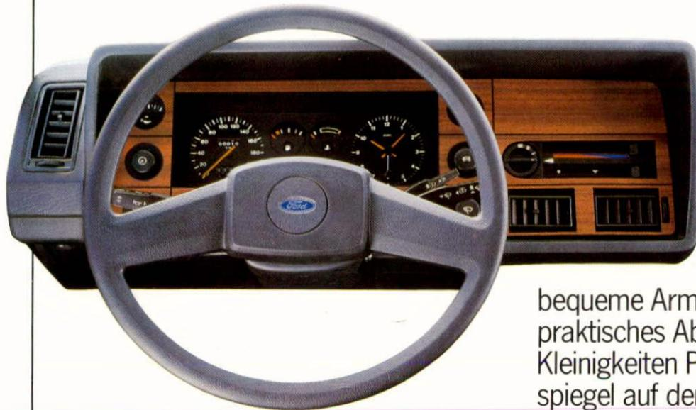
Übersichtlich gestaltetes Instrumentenbrett mit Öldruckmesser und Amperemeter.
