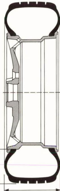
Niederquerschnittreifen: besonders breite Lauffläche im Verhältnis zur Flankenhöhe.
