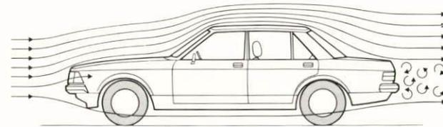
Die Linienführung der Karosserie entstand im Windkanal.
