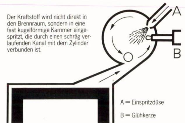
Der Kraftstoff wird nicht direkt in den Brennraum, sondern in eine fast kugelförmige Kammer eingespritzt, die durch einen schräg verlaufenden Kanal mit dem Zylinder verbunden ist.
