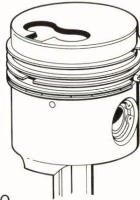
Eine kleeblattförmige Vertiefung auf dem Kolbenboden erzeugt eine mehrfache Verwirbelung der Verbrennungsgase und sorgt für eine optimale Ausnutzung des Kraftstoffs.
