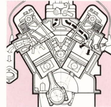
Der Querstromzylinderkopf sorgt für einen ungehinderten Gaswechsel. Das heißt: Mehr Leistung bei weniger Treibstoff.
