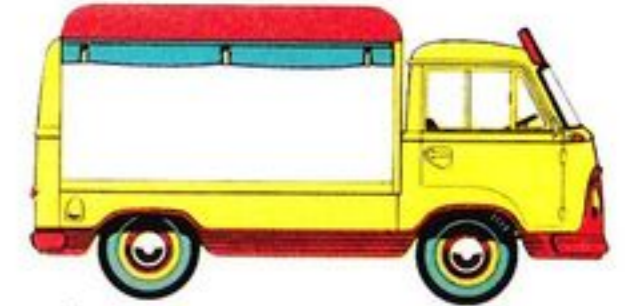
Getränkewagen: zweckmäßig eingerichtet für schnelles und müheloses Laden von Getränkekästen, abgeschrägter Boden.
