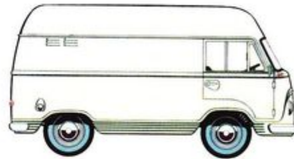
Großraumkasten: bis 7 m 3 Laderaum; Doppelflügeltür im Heck; Nutzlast bis zu 1175 kg; für sperriges Ladegut.
