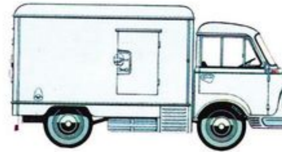
Tiefkühlwagen: wahlweise mit Trockeneisverdampfer oder Kälteaggregat; entspricht den Richtlinien des BVM.
