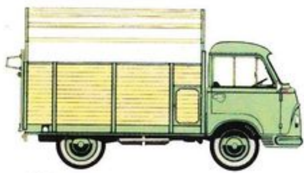
Viehtransportwagen: auf Tiefchassis aufgebaut; hintere Ladetür als Rampe, seitliche Tür für Kleinvieh. Enorme Tragkraft.
